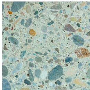
Figure 7 : Exemples de coloration dans la masse, du béton poncé avec D_{max} 16 et D_{max} 32 (à l'extrême droite)
