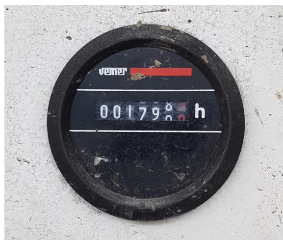
Ex. de compte-heures installé sur machines CIFA
